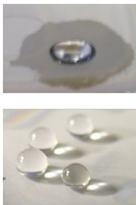
図 3 フッ素系両親媒性高分子微粒子薄膜上の濡れの一例 (上)トルエン、(下)水。
