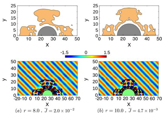
図8 異なる半径に対する最適解とそのとき得られた磁場
