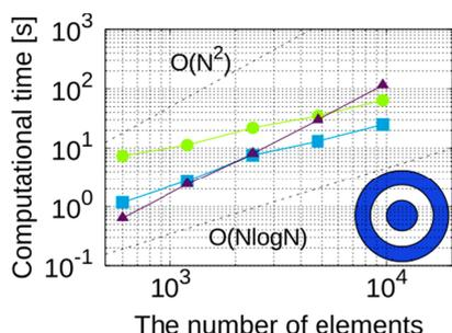
図 4 H マトリックスによる計算時間（印）と高速多重極法と GMRES による反復解法の組み合わせ（印）および GMRES による反復解法（印）の比較
