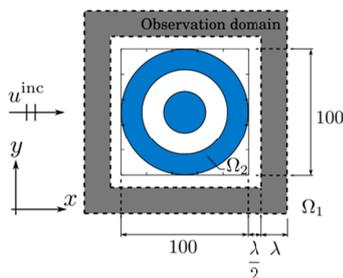
図 3 H マトリックスの計算効率化のための例題（二重円筒領域による散乱波の計算）
