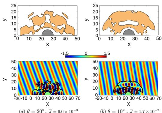
図9 異なる入射角度(左 20°, 右 10°) 対する最適解とそのとき得られた磁場
