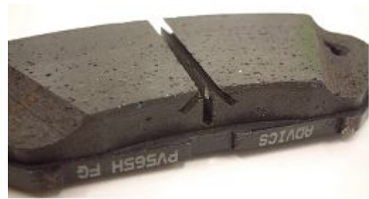
図6 改良したブレーキパッド (45° Slit)
