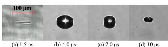
図7：気泡核生成と気泡成長の時間発展
