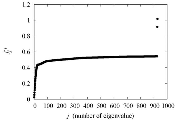
図6 系の固有振動数(二個の気泡)
