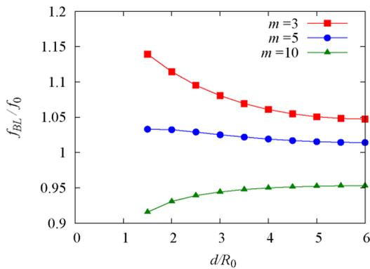
図9  $f_{BL}$ の管壁面と気泡中心との距離に対する依存性
