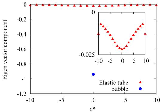
図4  $f_B$ に対する気泡半径と管壁面変位の固有ベクトルの成分
