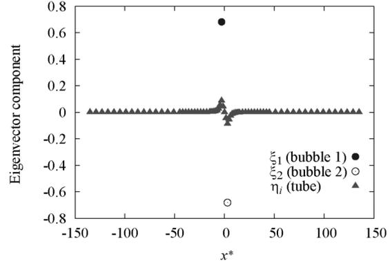
図8 二個の気泡振動と管壁面変位の固有ベクトルの成分( $f_{BH}$ )
