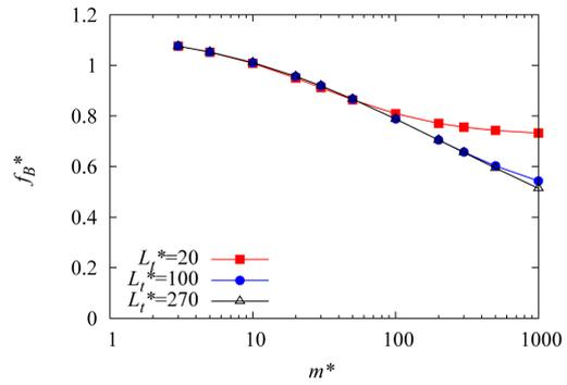
図5 管壁の質量と管長が共振振動数に及ぼす影響
