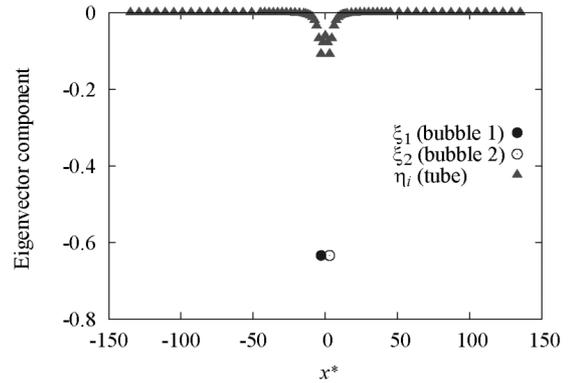
図7 二個の気泡振動と管壁面変位の固有ベクトルの成分( $f_{BL}$ )
