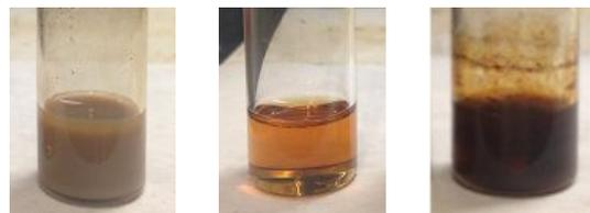
図3 左から、水素終端した SiNP をトルエンに分散させた二元シリコンインク、ドデセンで表面修飾した場合、さらに PS を添加した三元シリコンインク。
