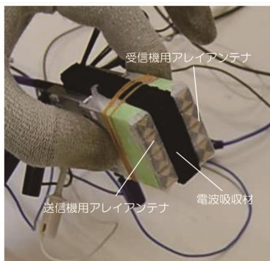
図2: マルチスタティック計測用アレイアンテナ
