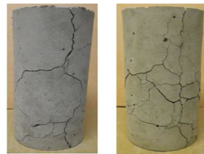
図 - 6 供試体に生じたひび割れの例
