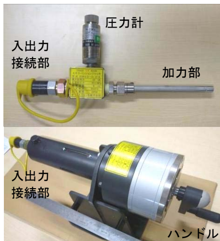
図-1 開発したジャッキシステム
