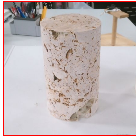
写真 1 琉球石灰岩ブロックからくり抜いて作製したコアサンプル(およそ φ100 mm x L170 mm)
