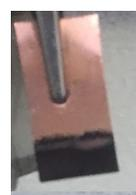
図 6  $50 \text{ mmol dm}^{-3} \text{Y}(\text{Tf}_2\text{N})_3 / \text{TMPA-Tf}_2\text{N} / \text{G2}$  浴の電析後の作用極
