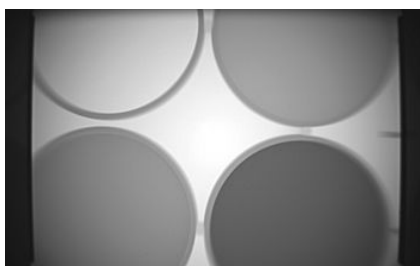
図 3. X線画像(鉛直方向照射) (右上が油相、右下が塩水、左下が水)
