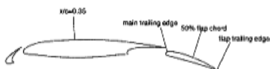
図 6 翼高揚力装置 (slat/main wing/flap)
