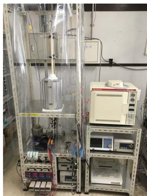
図 3 SOEC 評価実験装置
