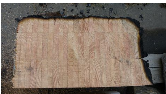
写真 1 ベイマツ集成材のみの 1 時間耐火試験における炭化の様子
