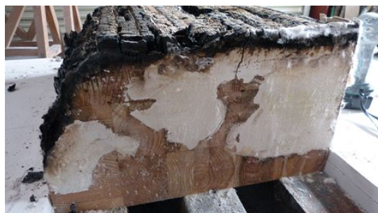
写真 2 スギ集成材 + ベイマツ集成材の 1 時間耐火試験における炭化の様子
