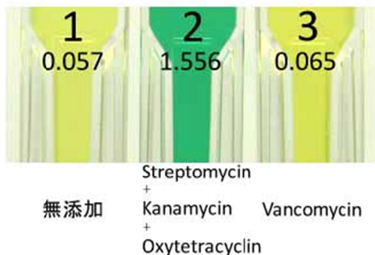
図4. 抗生物質の添加の有無による硝化活性の違い。アンモニア検出試薬を濾過槽内海水に添加した後の発色状況。1: 無添加槽、2: 3種の抗生物質を添加した槽 3: バンコマイシン添加槽。水槽番号の下の数値は 660nmでの吸光度。
