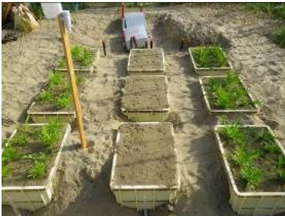
図 1 地下水上昇制御を調べるための圃場試験
