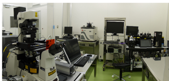
図1 高知コア研究所シングルセルラボ レーザーマイクロダイセクション、セルソーター、分注機などがクリーンルーム内に配置されている。
