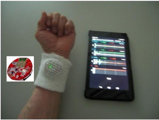
**図3 モーションセンサによる左腕随意屈伸運動の計測**
