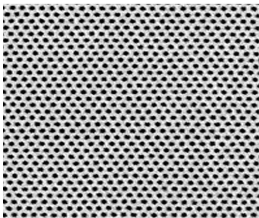
図2 自己組織的に長距離規則構造を形成した陽極酸化ポーラスアルミナ (周期 100nm)
