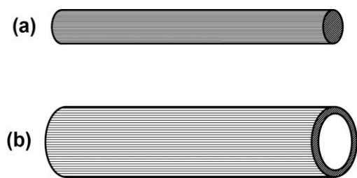
図1 プラズモニック導波路の模式図 (a)ナノワイヤー、(b)ナノホール
