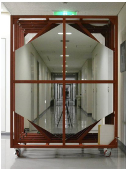
図 4. 「ラック」に入った状態の full size の CTA 大口径望遠鏡用の分割鏡。
