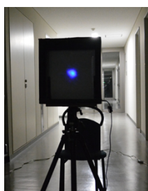
図 6. スクリーン上に映る、2f 法による分割鏡の反射像の写真。
