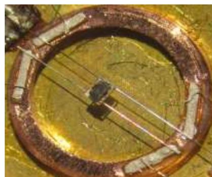
図2. 作製した高感度比熱測定システムのアデンダの写真
