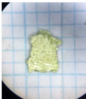
図 3 Flux 法で育成した CFMO の単結晶
