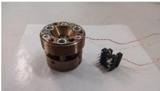
図 4. ダイヤモンドアンビルセル
