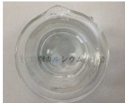
水中に 1 週間静置したリン酸カルシウム透明成形体
