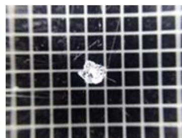
図10 スケール上の雪粒の写真、雪粒をスケールの上にのせて粒径を測定する。
