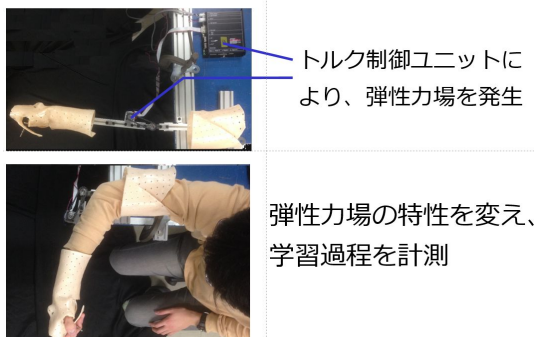
図4 人の運動学習過程の計測装置
