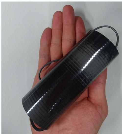
図1: ASIC プリアンプ内蔵サーチコイルの試作モデル
