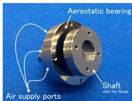
図3 複合型静圧空気軸受（ラジアル方向に2箇所、スラスト方向に1箇所に多孔質金属焼結体を嵌合し、それぞれに供給する圧縮空気をデジタル電磁弁によって調整する。それにより、空気の流れによって生じる軸の回転を抑制する機能を備える。）
