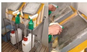
図 2 供試体の設置および散水
