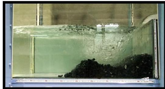
図 1 落下流によるマウンド変形実験
