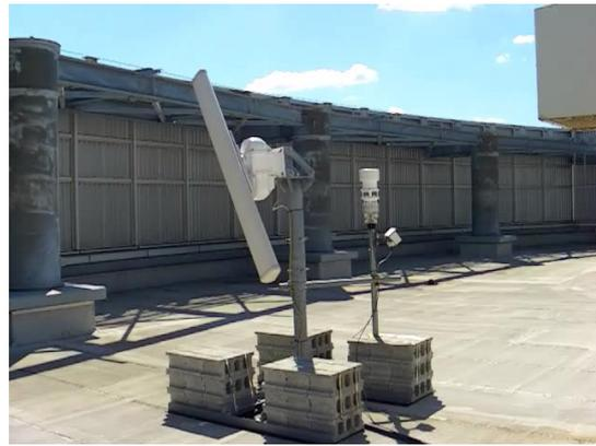
図1 船舶レーダー(MDC-2920/光電製作所)の設置状況。アンテナを縦向きに取り付けることで降雨の鉛直分布を捉える。船舶レーダーの後ろに設置してあるのが複合気象装置と屋外カメラである。
