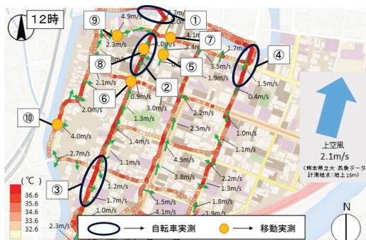
図2. 12時台の実測結果(気温分布・風速)
