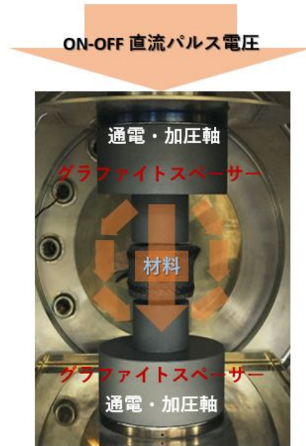
図 1 パルス通電焼結部の構造
