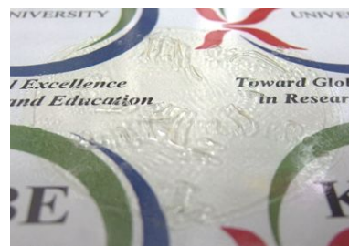
図 6 DN イオンゲル薄膜 (膜厚: 58 μm, イオン液体含有量: 約 80 wt%)
