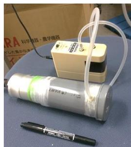
図 2. 閉鎖循環式チャンバ法による根呼吸速度測定の様子。
