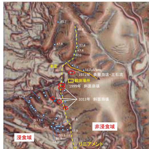
図-3 微地形図 (CS 立体図) を用いた地形判読と湧水調査の結果
