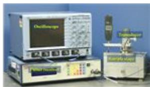
図1 超音波測定装置
