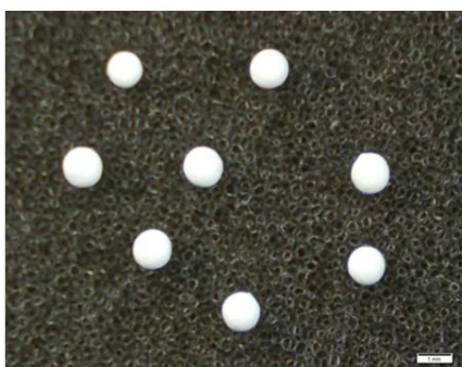
図7 W/O エマルジョン法で調製した石膏小球
