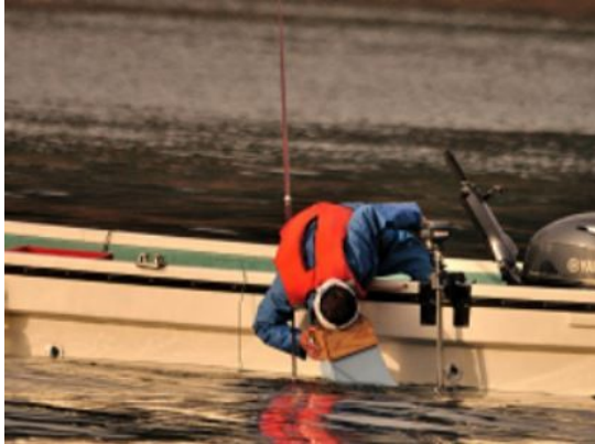
図1 操船(右手), 採集(左手), ゴーグル把持(口)を同時に行う作業者。操船が自動化できれば, 身体負担と作業効率を改善できる。
