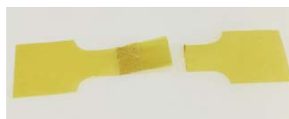
(b) せん断剥離試験片
