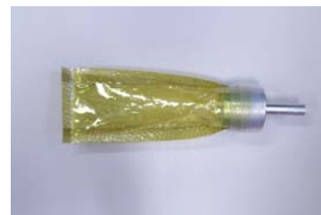
(a) T 字剥離型バルーンアクチュエータ
