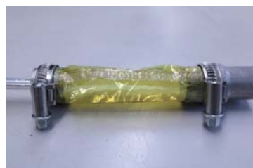
(b) せん断剥離型バルーンアクチュエータ
