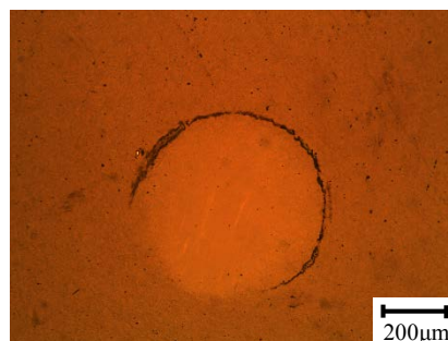
図 2 (a) 3000 回押し付けた後の DLC 膜
