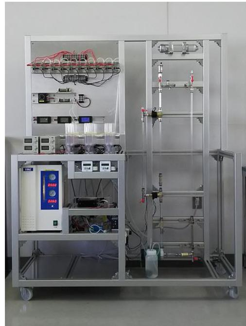
図2 構築した省エネルギー型プラズマ水質浄化システム
