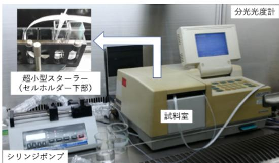
図3 濁度調整システムの外観
