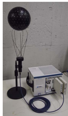
図 1：研究代表者開発の球状マイクロホンアレイを用いた 3 次元音空間収録・再生技術
