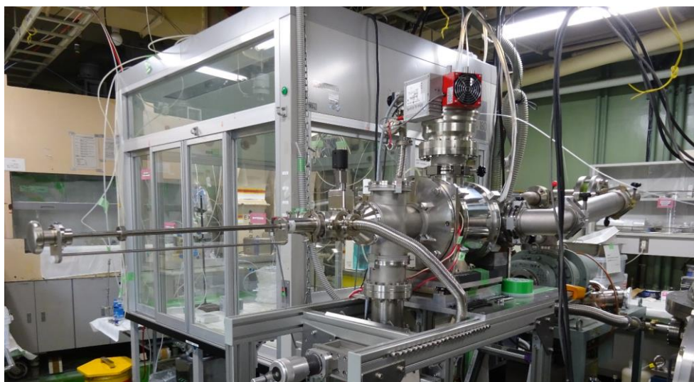
写真1. 原子ビーム発生装置テストベンチ
