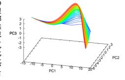
(Reservoir Computing による波形伝播エミュレータの作成と予測)再帰型ニューラルネットワーク (Recurrent Neural Network, RNN) の一つである Reservoir Computing(RC)を用いて,トンネル微気圧波データセットに対して時間波形の空間伝播エミュレータの作成を機械学習的手法により行った.学習済みエミュレータによる波形の再現性は非常に良く,時間波形の空間発展予測性能も非常に高いことが判明した.そのため,RCによるエミュレータはトンネル微気圧波の
