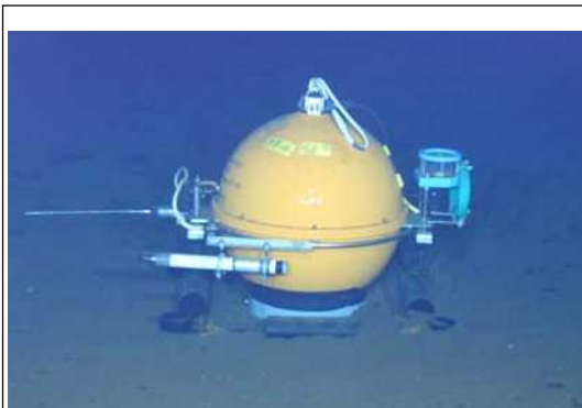
図1 自己浮上方式の広帯域海底地震計。
