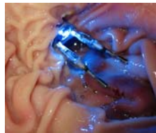
図1 摘出臓器を用いた食道から胃に到達したロボット先端部の様子
