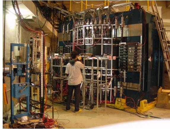
図3 東北大学原子核理学研究施設 (現電子光学センター) に建設・設置した中性 K 中間子スペクトロメータ (NKS2) の写真
